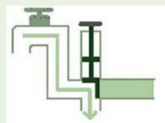
不凍栓で水が止まり、蛇口(給水装置)を開けることにより、管の水が排出されます。
