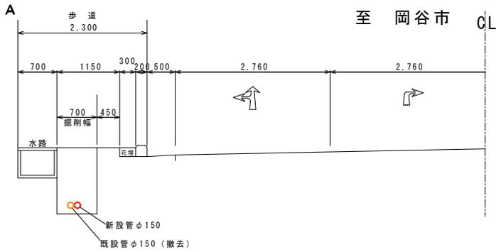
Φ150配水管掘削図 S=NON SCALE
