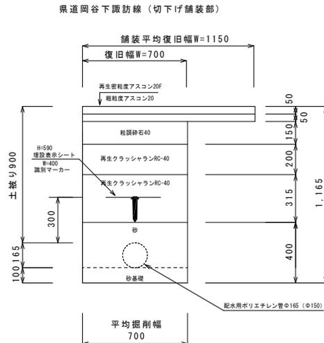
配水管ポリエチレン管φ150 分岐口径φ20・25
