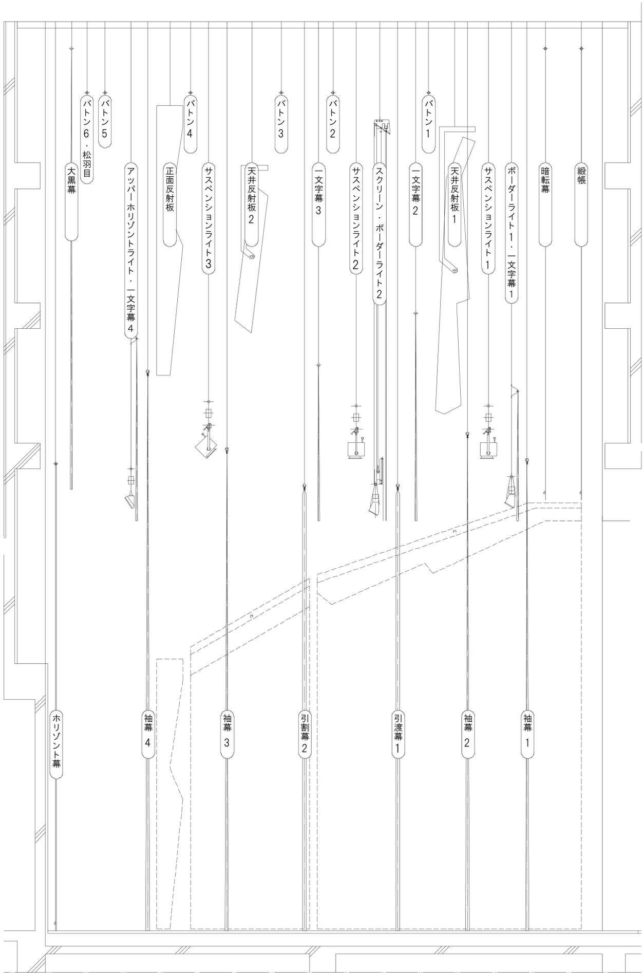
舞台吊物昇降装置 吊物断面図
