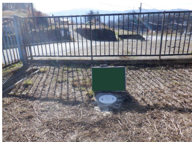
地下水観測孔の例
