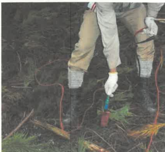
地震計・観測線の設置状況
