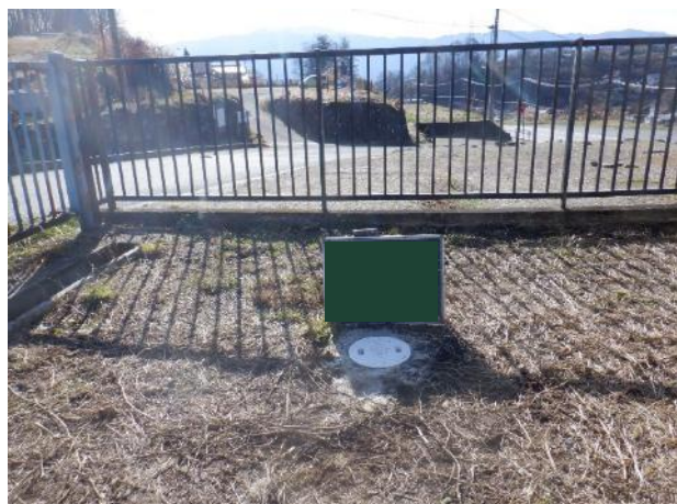
地下水観測孔の例
